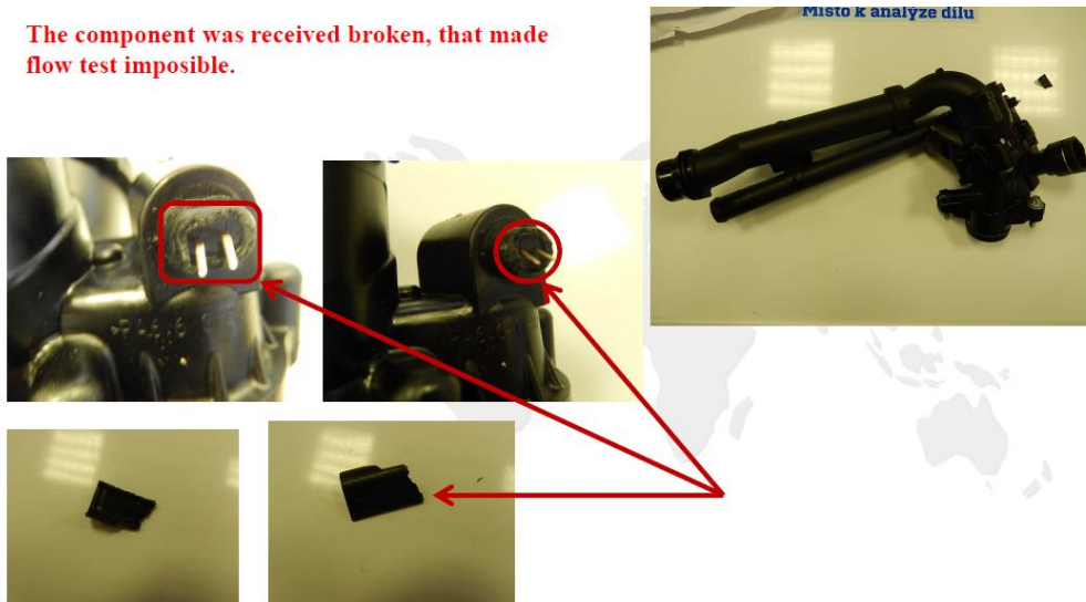
Obrázek 1: Zamítnutá garance (rozbitý díl)
